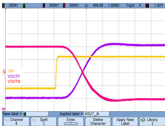
图 50. AMC1301 器件的阶跃响应
